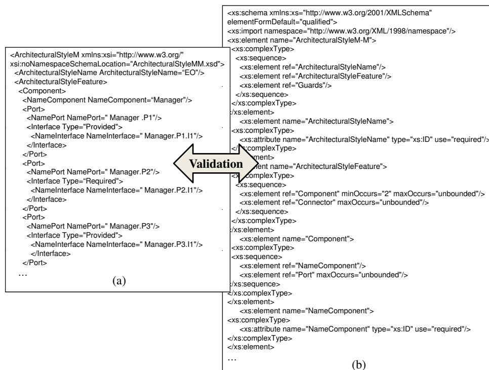
FIG. 4.2 – Validation de la description XML (a) par rapport à son XML Schéma (b)
