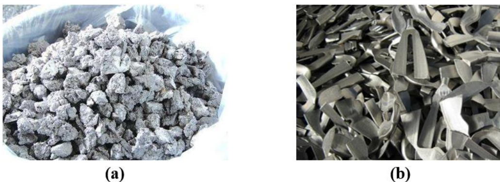
Figure I.1 : (a) Eponges de titane pur ; (b) Déchet de titane
