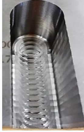
Figure III.17 : Surface générée par l'outil AJX ( kr > 90^\circ )
