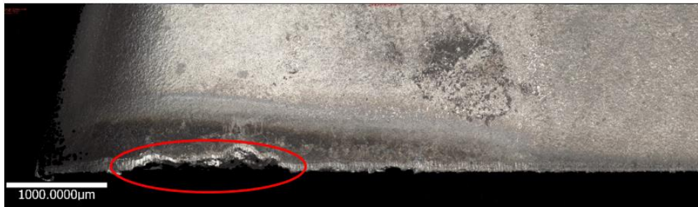
Figure II.31 : face de dépouille en fin de vie de la plaquette JL après 22 min d'usinage ( V_c = 60 \text{ m/min} ; f_z = 0.2 \text{ mm/dent} ; a_e = 4 \text{ mm} )
