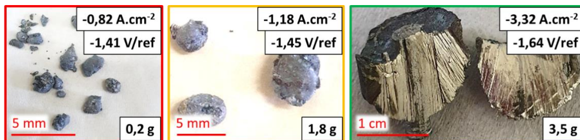
Figure V- 5 : Photos du Nd métallique récupéré après des électrolyses dans \text{LiF-NdF}_3\text{-Nd}_2\text{O}_3 i = -0,82 \text{ A.cm}^{-2} (rouge), i = -1,18 \text{ A.cm}^{-2} (orange), i = -3,32 \text{ A.cm}^{-2} (vert), T = 1050^\circ\text{C} , Q = 10\,044\text{C} , Cathode : Mo, Anode : graphite, Référence : carbone vitreux
