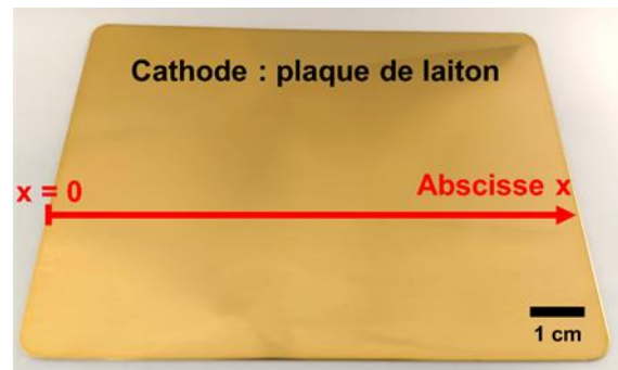
Figure 77 : Photographie d'une plaque en laiton jouant le rôle de substrat à la cathode.
