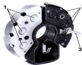
1. Diode négative 2. Diode positive 3. Sortie + batterie
