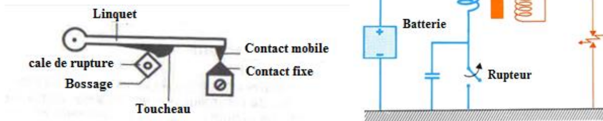
Figure 2.21 : Synoptique d'un rupteur (gauche) et branchement sur le système (droite)
