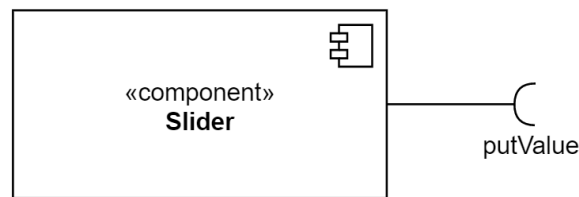
Figure 1.2 – Représentation en UML 2.0 du composant Slider avec un service requis putValue
