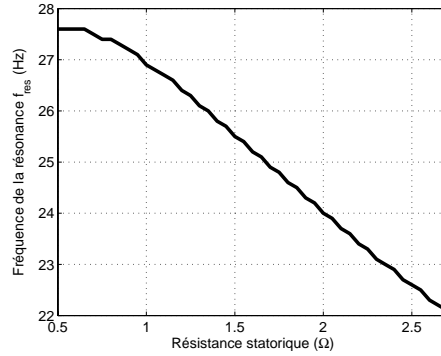
(c) Fréquence de la résonance en fonction de la résistance statorique
