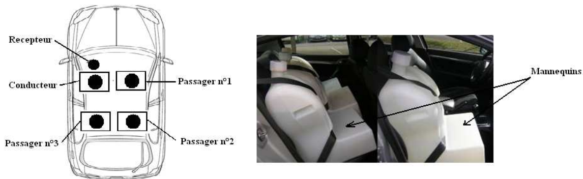
Figure.2.37 : procédure d'expérience de l'influence du nombre de personnes sur le canal de propagation TPMS
