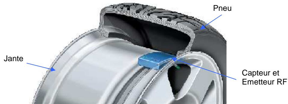
Figure.2.1: principaux éléments constructifs d'une source TPMS
