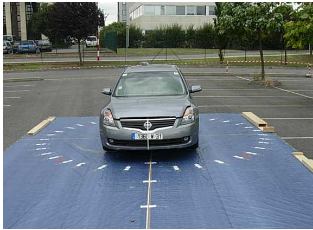
Figure.2.51 : système de caractérisation du canal radio pour le système d'accès radio
