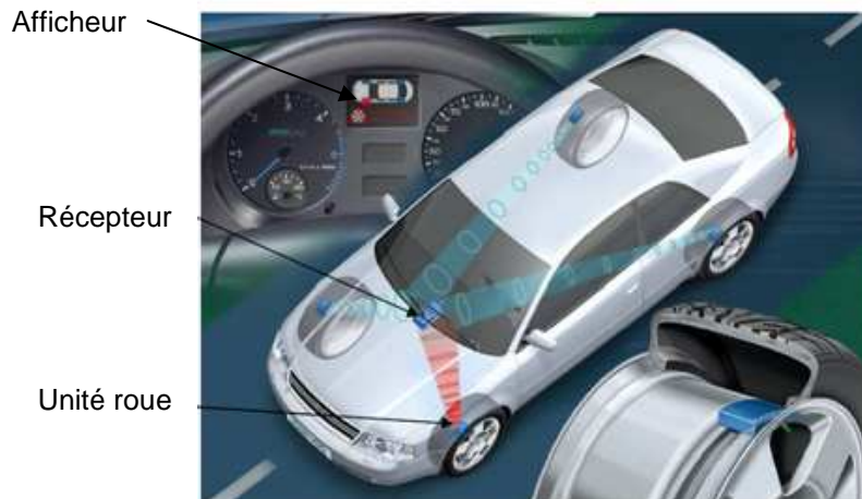
Figure.1.4. système direct de surveillance de la pression des pneumatiques
