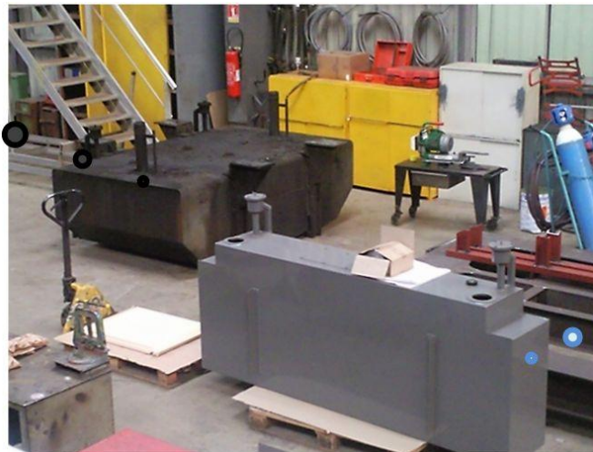
Figure 1.23. Réservoirs de gasoil des deux locomotives BB63000 et PLATHEE
