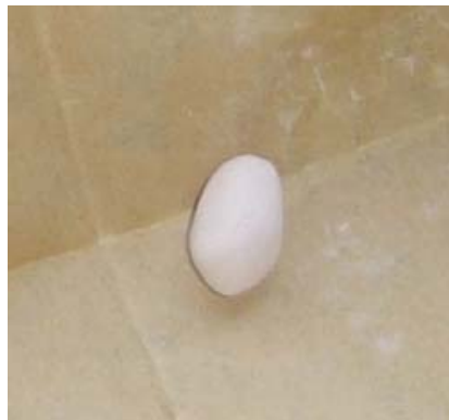
Figure 32: Graphite compacté (15 % de kaolin)
