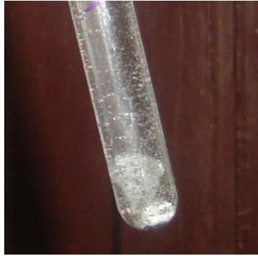
Figure 23 : Dissolution du Zn dans le HCl
