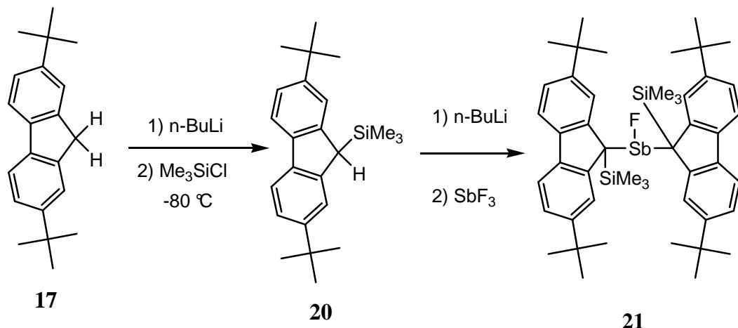
**21** a été caractérisé par ses données physico-chimiques. Ainsi, l'analyse en RMN du carbone révèle pour le carbone 9 la présence d'un doublet à 59,63 ppm avec une constante de couplage  $^2J_{CF}$  de 11,3 Hz. Le déplacement chimique en fluor à -139,8 ppm est caractéristique d'un produit monofluoré de l'antimoine.
