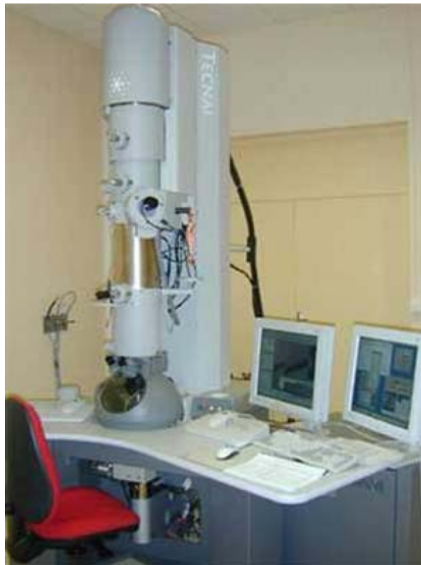
Figure A3-1 : SACTEM FEI Tecnai TM F20. Le correcteur d'aberration sphérique est situé sous la lentille objectif (partie brillante au niveau de la colonne).
