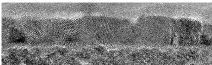
13 nm La-ZrO 2 recuit 400°C 60s sous N 2
