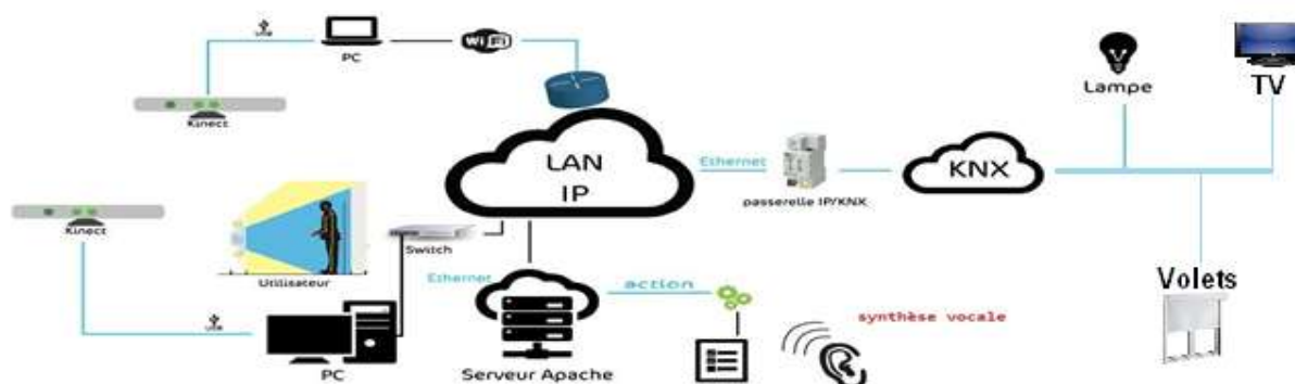
Figure 57. Interconnexion réseaux IP/KNX
