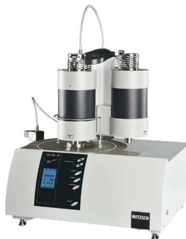
Figure II.2. (a) Photo des nanolaminés Al/CuO 2:1 fabriqués (épaisseur Al :200 nm ; épaisseur CuO : 200 nm) après décollement du substrat pour analyse thermique. (b) photo de l'appareil DSC NETZSCH404 F3 pegasus.
