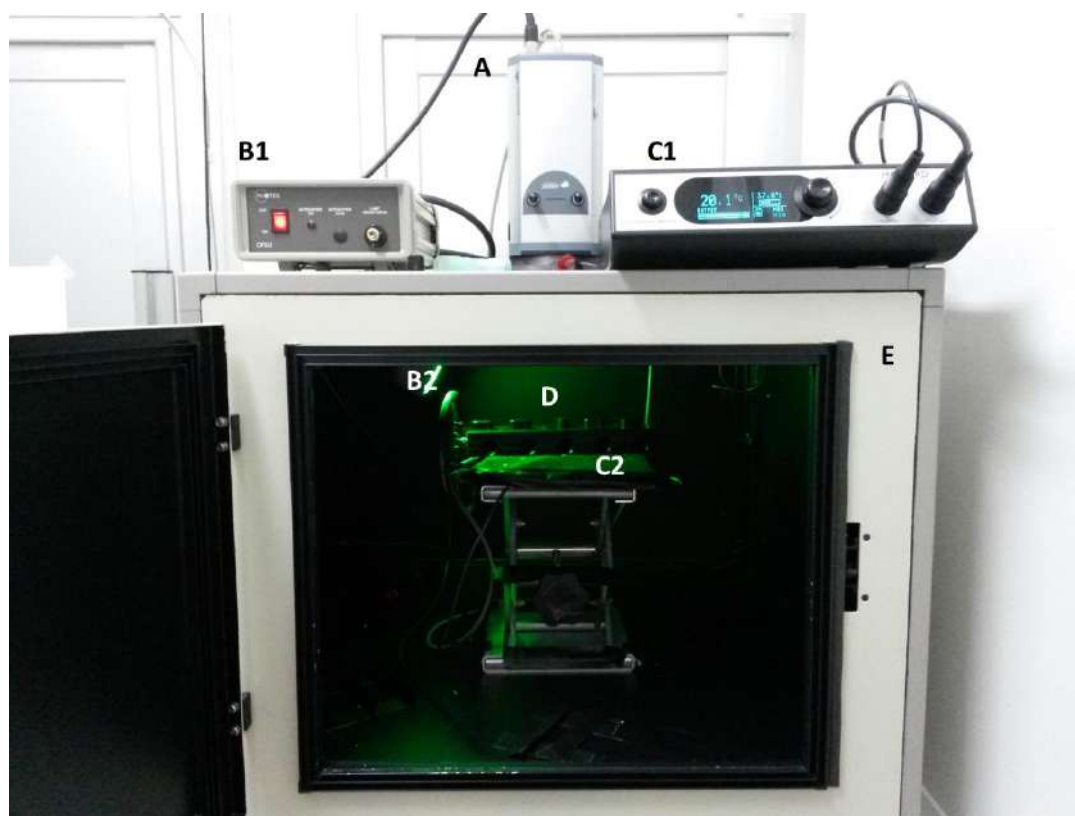
Figure 69: Dispositif pour l'imagerie non invasive de bioluminescence. (A) Caméra. (B1 et B2) Alimentation et lumière pour le positionnement des animaux à l'intérieur de la boîte noire. (C1 et C2) Alimentation et tapis chauffant. (D) Masques d'anesthésie gazeuse. (E) Boîte noire.
