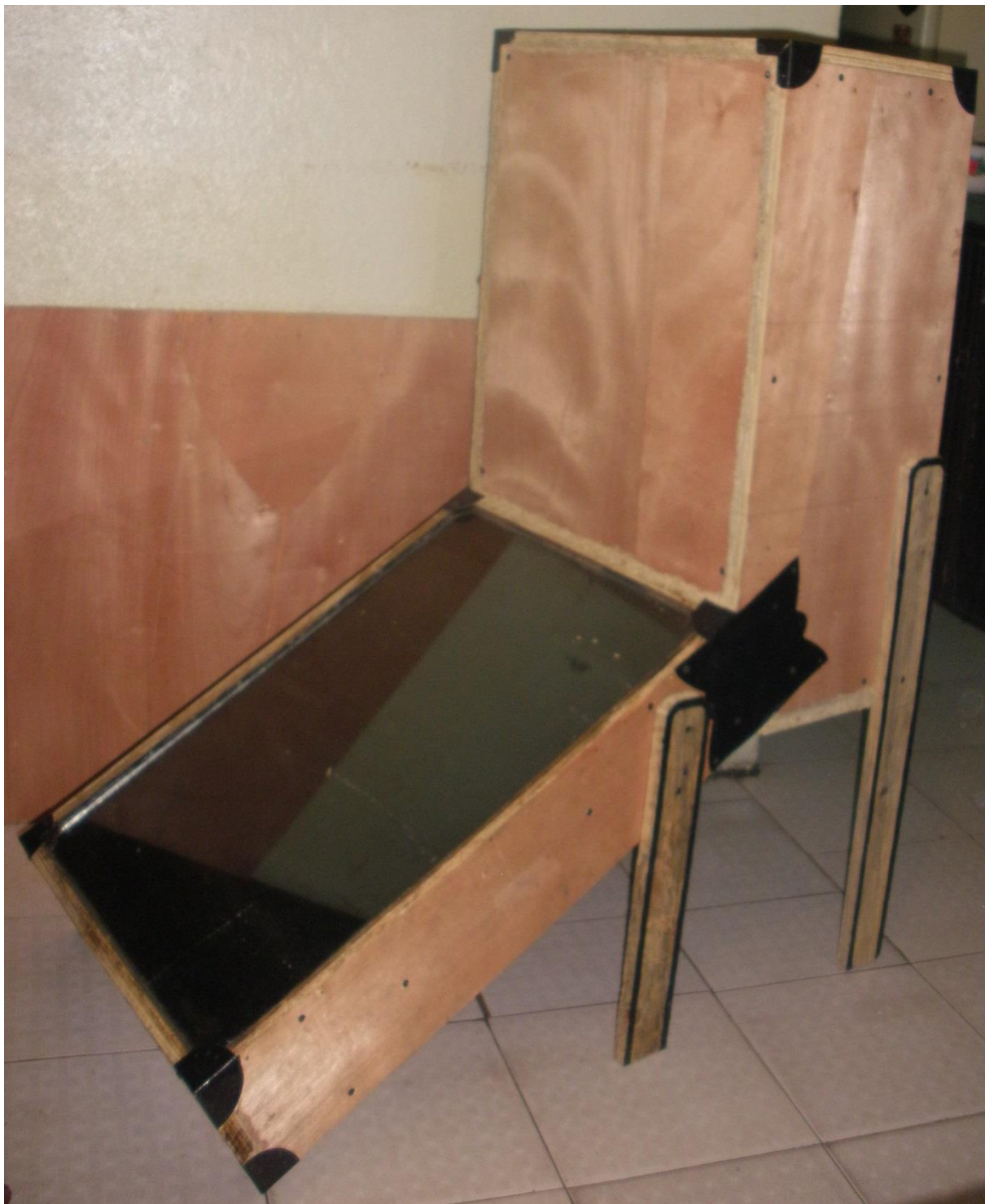
Photo 1 : Le séchoir solaire passif de type indirect
