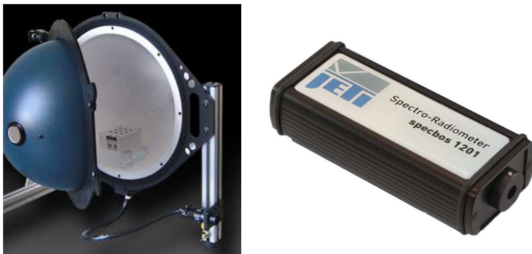
Figure 3.3 : Photos de la sphère d'intégration LMS-100 et du spectroradiomètre Specbos 1201
