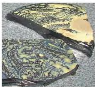
Figure 10 : Photographie d'un verre de type R7T7 à taux de charge élevé en \text{MoO}_3 (3 % massiques) élaboré en laboratoire et refroidi par coulée sur plaque. La « yellow phase » est observée à la surface du verre [50].
