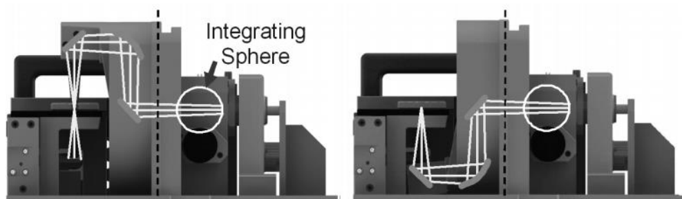
Figure 3-4 : Module 8RT du spectrophotomètre Lambda 1050. A gauche configuration pour la mesure en transmission. A droite configuration de la mesure en réflexion
