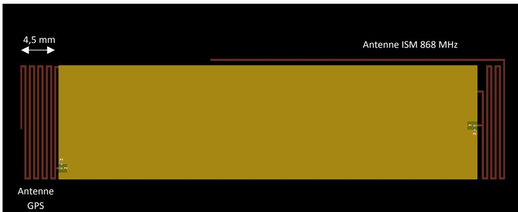
**Figure 2.42 :** Premier design de l'antenne GPS.
