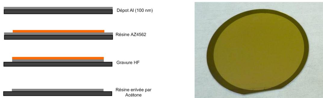
**Figure 4.48** : Dépôt de la couche d'aluminium.
