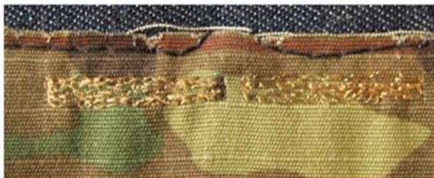
**Figure 1.10** : Antenne réalisée avec des fils de cuivre
