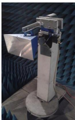
Figure 5.8 : Antenne de calibration.
