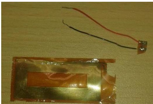
**Figure 4.35** : Décollement des connexions métalliques et polyimide.
