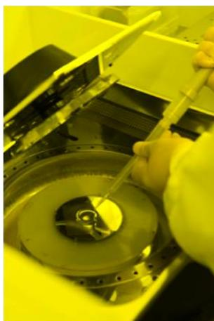
Figure 4.9 : Dépôt de la résine par enduction.
