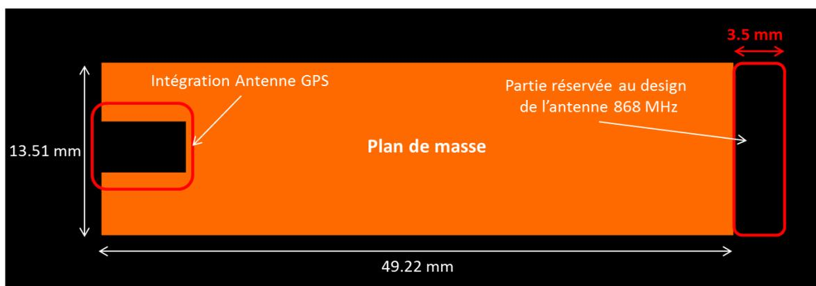
Figure 2.28 : Contraintes d'intégration de l'antenne ISM 868 MHz.
