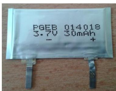
Figure 3.1 : Batterie LiPo utilisée dans le patch.
