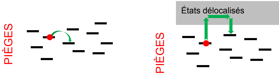
Figure I.12 – Schémas des mécanismes de hopping (gauche) et de multiple-trapping-and-release (droite).
