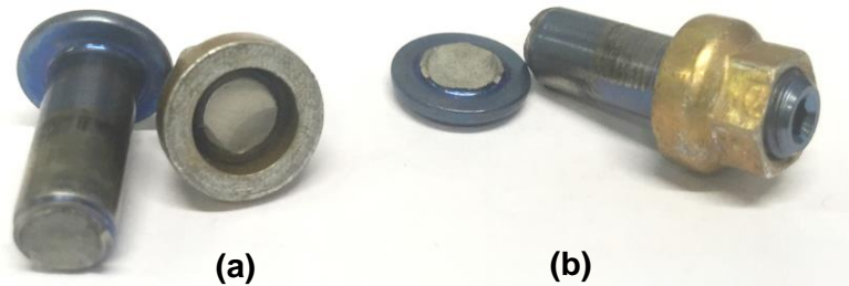
Figure 4. 35 : Modes de rupture observés : (a) rupture dans le premier filet en prise, (b) rupture sous la tête de fixation
