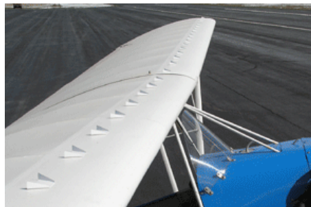
Figure 1.24 – Illustration d'un générateur de vortex passif type tabs , installés sur Stewart Headwind
