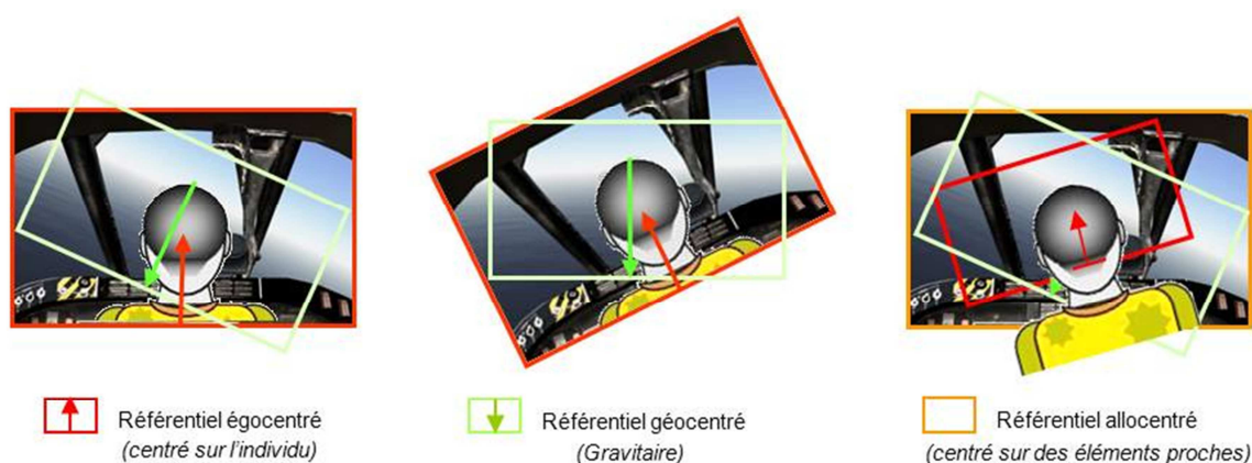
Figure 1.7. Exemple de référentiels spatiaux. En aéronautique, il est primordial pour la sécurité humaine de bien distinguer les différents types de référentiels spatiaux : égocentré centré sur l'avion et son pilote, géocentré centré sur l'espace terrestre, et allocentré centré sur des éléments proches de la cabine ou de l'espace. L'horizon terrestre constitue une référence primordiale en aéronautique. Son utilisation omniprésente souligne l'importance de mieux comprendre comment l'individu perçoit cette référence. Quand le pilote est aligné dans l'axe de sa cabine, les référentiels égocentré et allocentré concordent. Mais on peut très bien imaginer que pendant la phase de navigation le pilote soit lui-même penché à l'intérieur de sa cabine, induisant par là-même une dissociation entre référentiels égocentré et allocentré.
