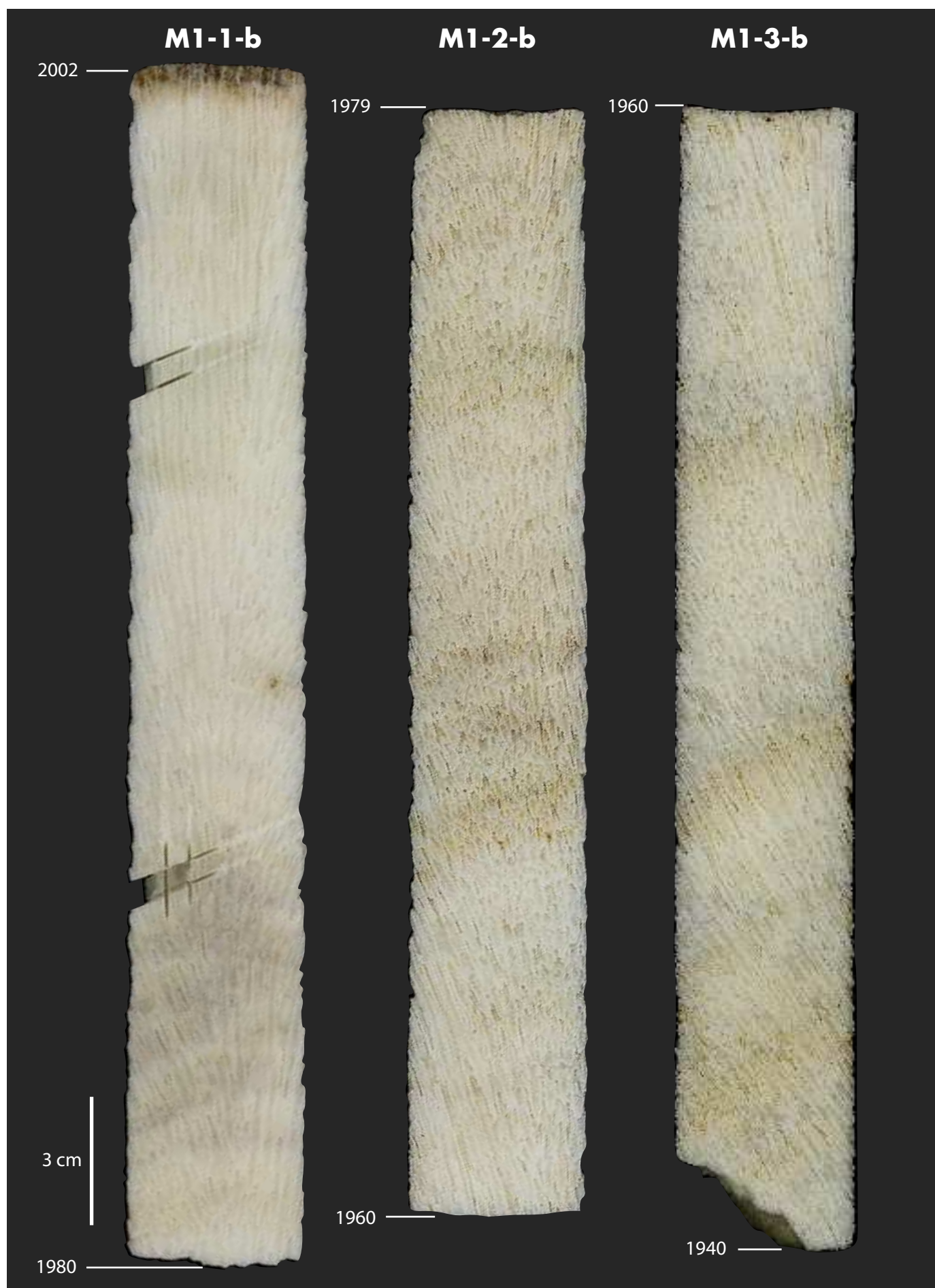
Figure 68 : Observation, en lumière visible de la carotte de Montastrea faveolta récoltée au large de la Pte Borgnesse (Martinique) en juin 2002.
