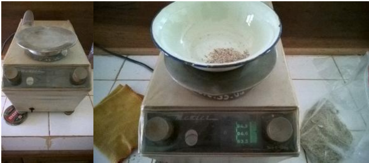
Photo 1 : Un tamisat mesuré sur la balance de précision
