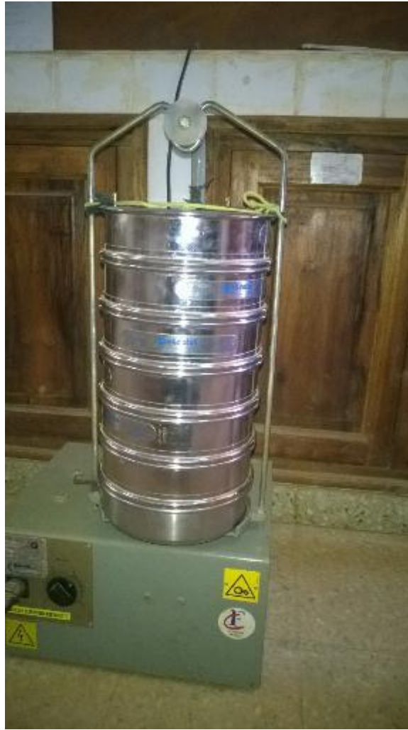
Photo 2. Une série de tamis posée sur la machine à secousse
