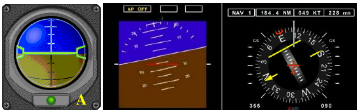
Figure 24 : Différents types de symbologies synthétiques utilisées pour l'indicateur d'horizon artificiel.
