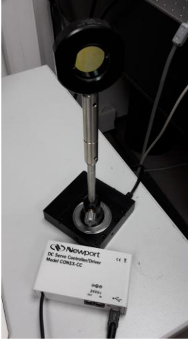
Figure 3-21 : Photographie du goniomètre et du miroir, éléments-clefs de la calibration.
