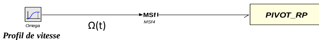
Figure III.10 - Modélisation bond graph de la motorisation en tant que source de vitesse
