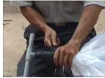
Photo n°18 : enroulement d'une bande de caoutchouc autour du plastique et du tube avec une bonne connexion entre les deux éléments
