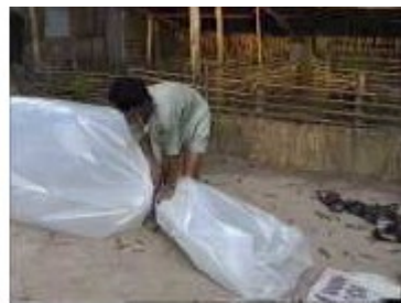
Photo n°12 : Le digesteur rempli d'air
