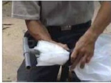
Photo n°18 : enroulement d'une bande de caoutchouc autour du plastique et du tube avec une bonne connexion entre les deux éléments
