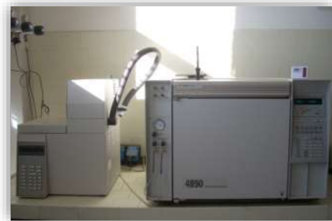
Figure 12 : HS-GC-FID Agilent 4890 utilisé pour l'analyse des composés volatils
