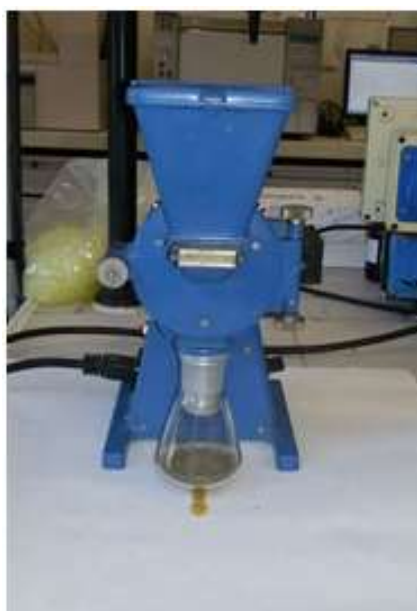
Figure 13: Broyage des feuilles de M. moschatus à l'aide d'un broyeur de marque MFC DCFH48 IKA-WERK.
