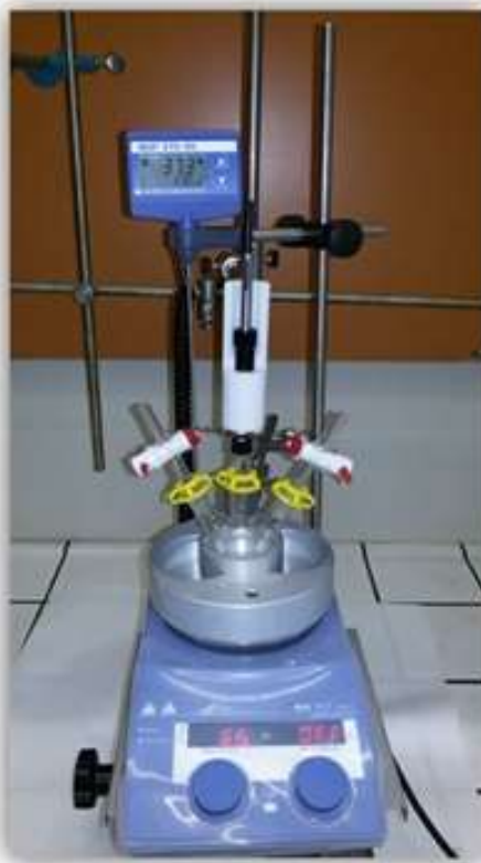
Figure 17 : Appareil pour l'analyse SPME des feuilles avec plaque de chauffage
