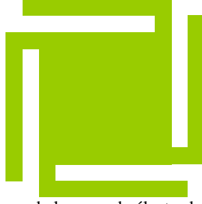
Figure 2-19 Schéma type de la seconde électrode d'un actionneur
