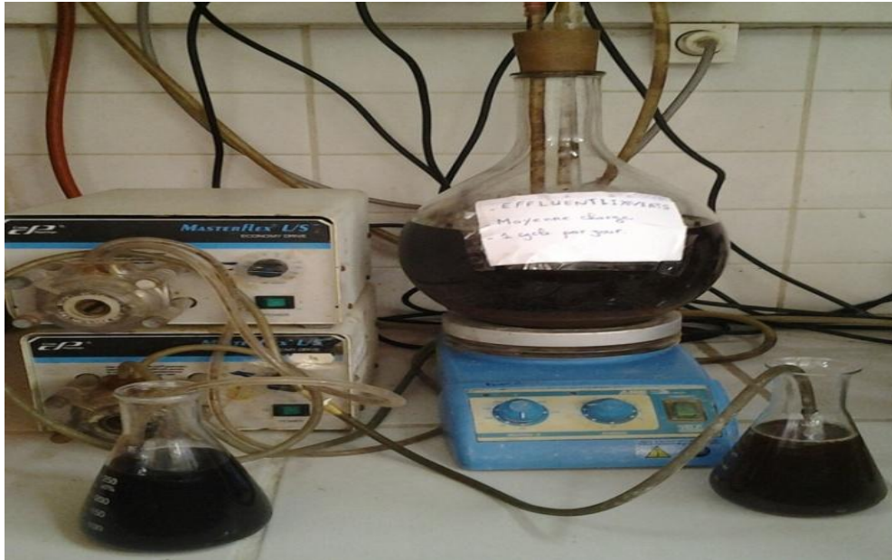
Photo 15: Procédé SBR pour le traitement de lixiviats
