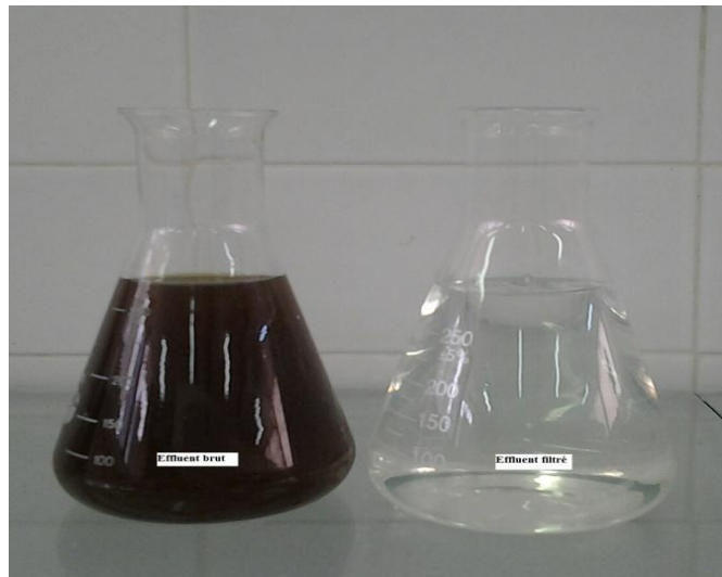
Photo 20 : Décoloration de l'effluent de lixiviats.
