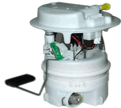
Figure1.21 : Pompe et régulateur immergés.[11]
