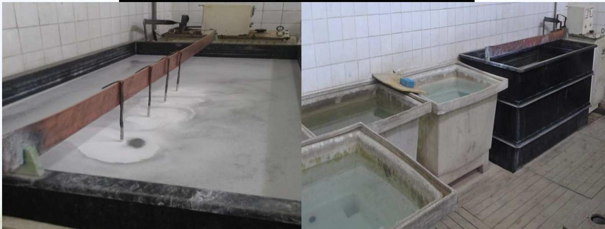
**Figure 14 : Bain de dégraissage**
