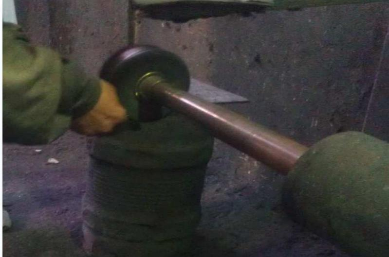
**Figure 10 : Polissage mécanique d'un article**
