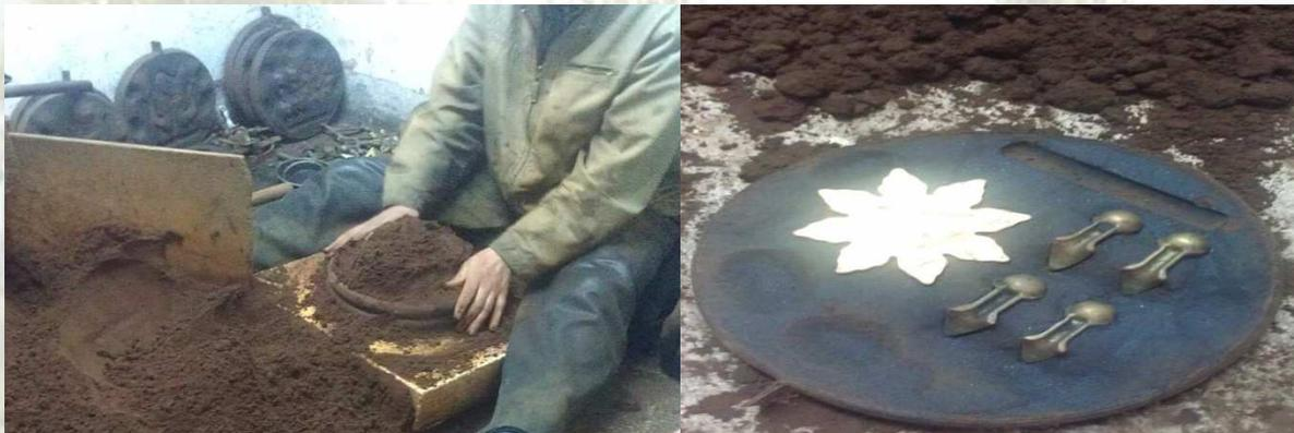
**Figure 6 : Fabrication D'un moule de sable**
