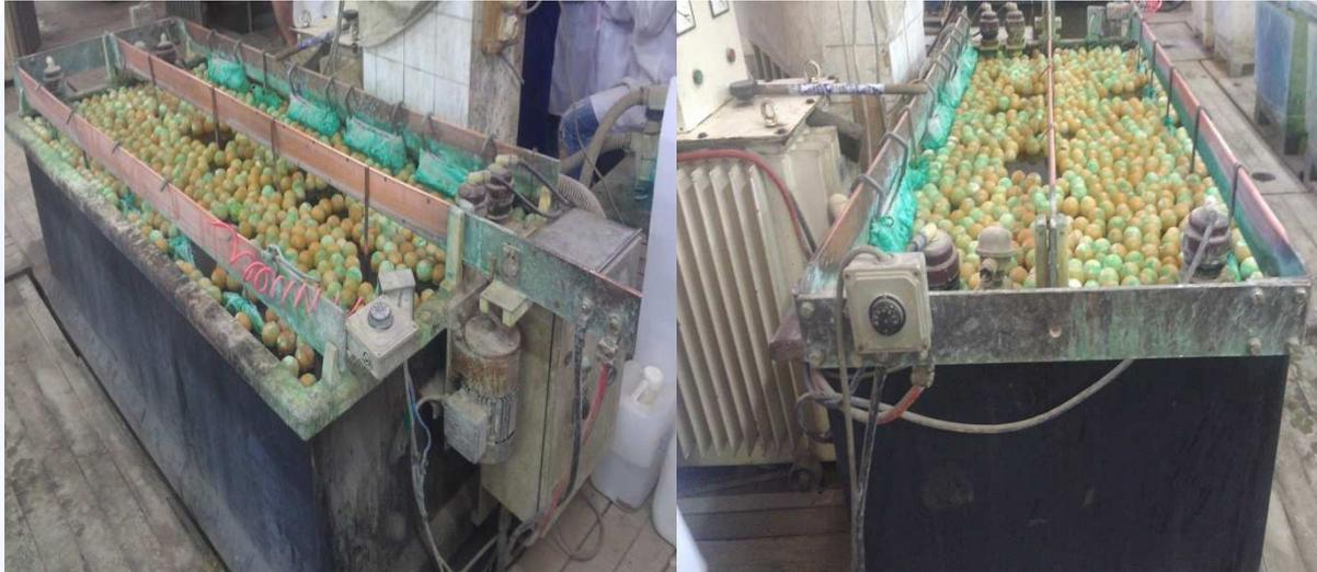
**Figure 18 : Bain de Nickelage**
