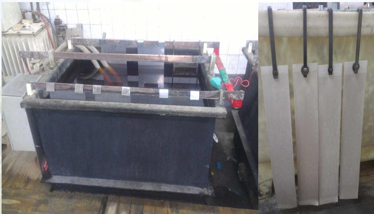
**Figure 20 : Bain d'argentage et les plaques d'argent**
