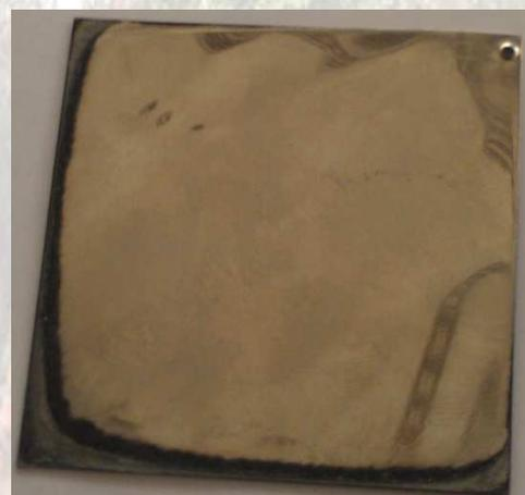
D'après cette expérience on a fait une variation au niveau de courant, lorsqu'on a une haute tension la pièce se rendra brûlée à cause de la haute tension exercée sur une pièce de petit diamètre.
