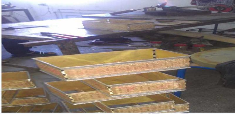
**Figure 8 : Pièces après soudure**
