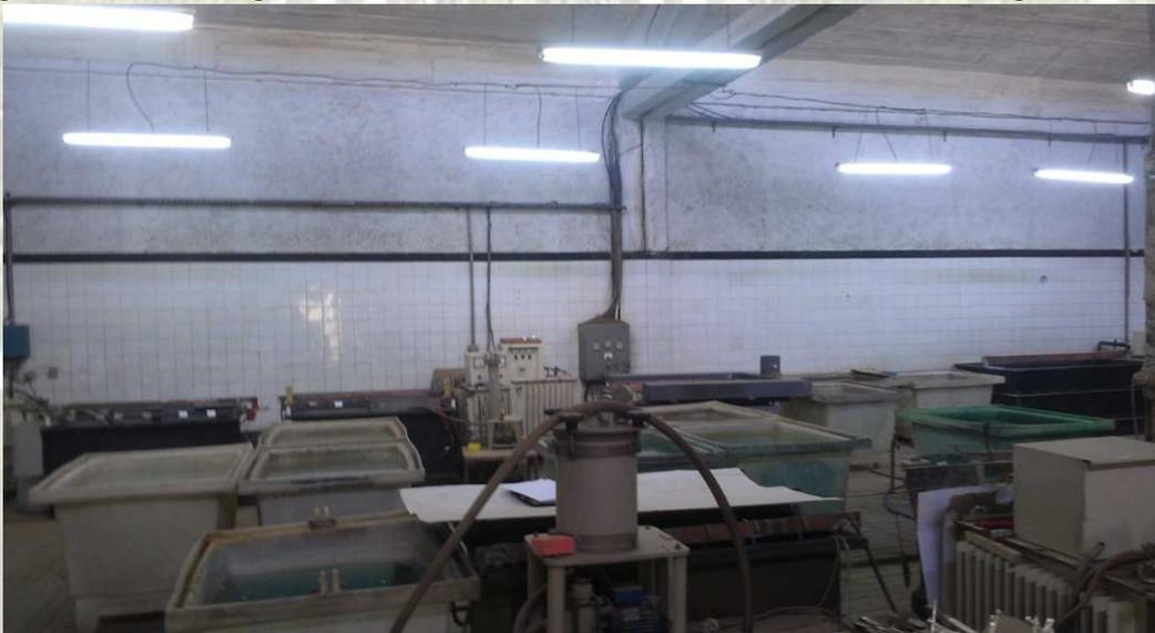
**Figure 11 : Bains de traitement de surface**
