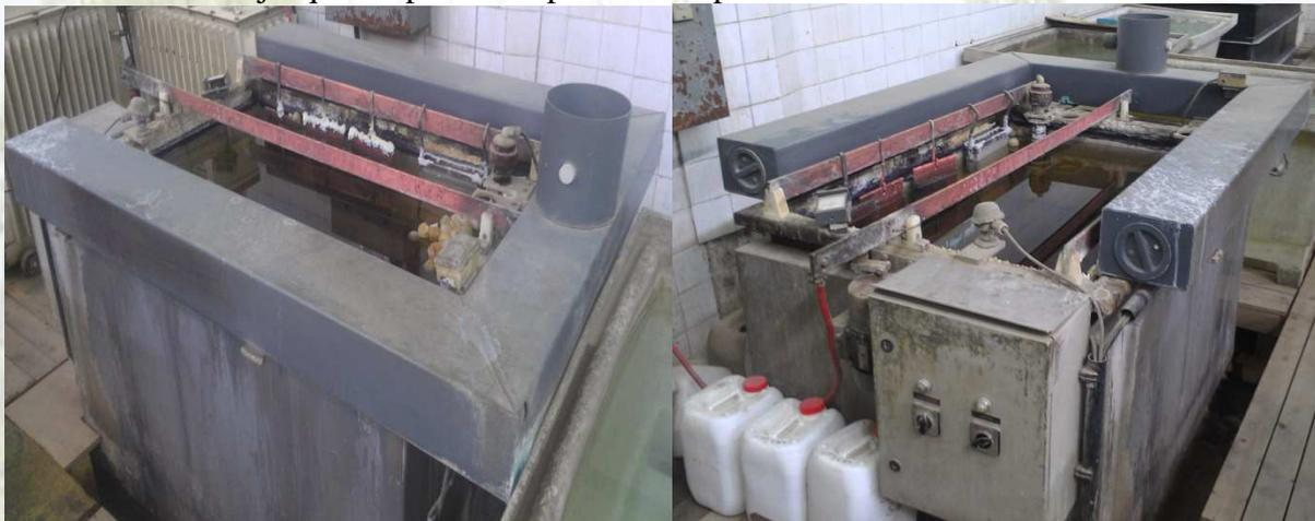
**Figure 16 : Bain de cuivrage alcalin**
