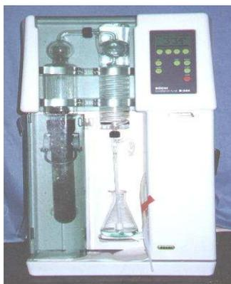
Figure 5 : L'appareil de Buchi utilisé pour la Distillation
