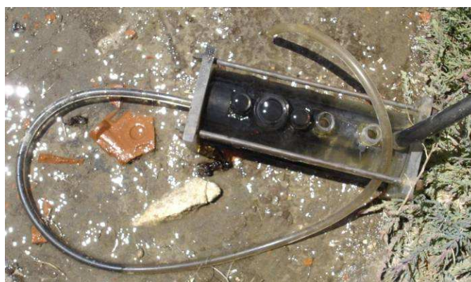
Fig. 74. Dépôts noirs laissés par l'eau du piézomètre S 1 dans la cellule de mesure
