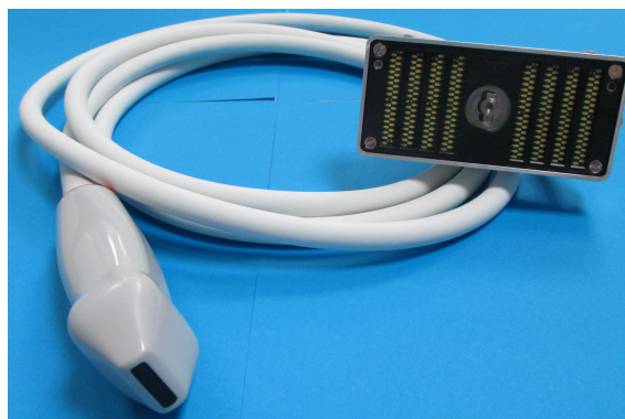
FIGURE 9.4 – Photographie de la sonde complète de 128 éléments à base de \text{KNbO}_3
