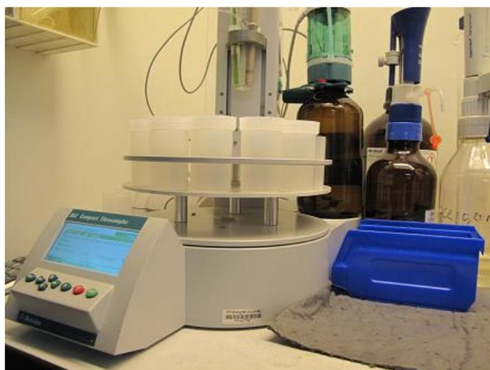
Figure 63 : Photographie du titreur automatique « Compact Titrosampler 862 »
