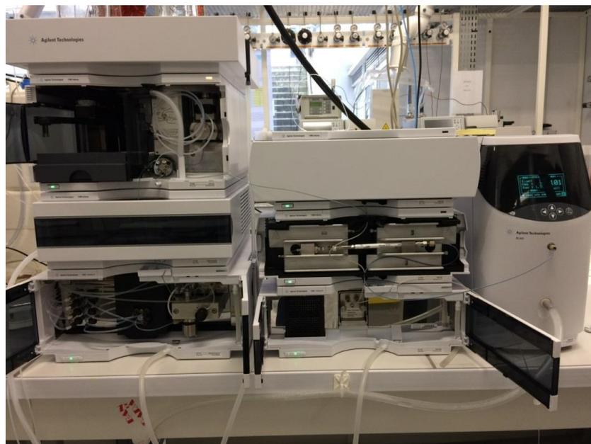
*Figure 65 : Photographie de la chaîne HPLC « Infinity 1260 »*
