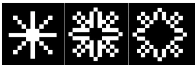
FIGURE 4.16 – Représentation de la frontière d'une étoile (à gauche), de la frontière de son dilaté par un voisinage  $V_4$  suivant notre méthode (au centre) et de la frontière du dilaté souhaité (à droite).
