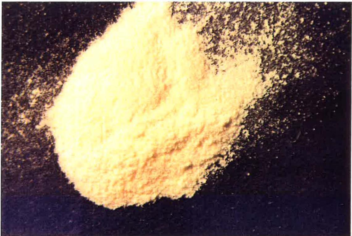
**Figure III.3b.** : *image d'un résidu de calcination à 823K ( $p_{CH_4}=0,67$  kPa et  $p_{H_2}=0,17$  kPa)*
