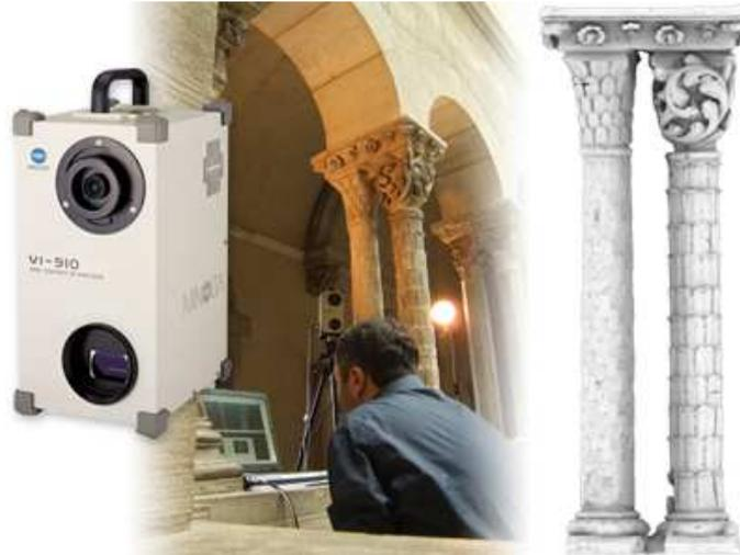
**Figure 36** Un scanner laser 3D à triangulation optique et le résultat obtenu (maillage polygonal d'un élément sculpté).
