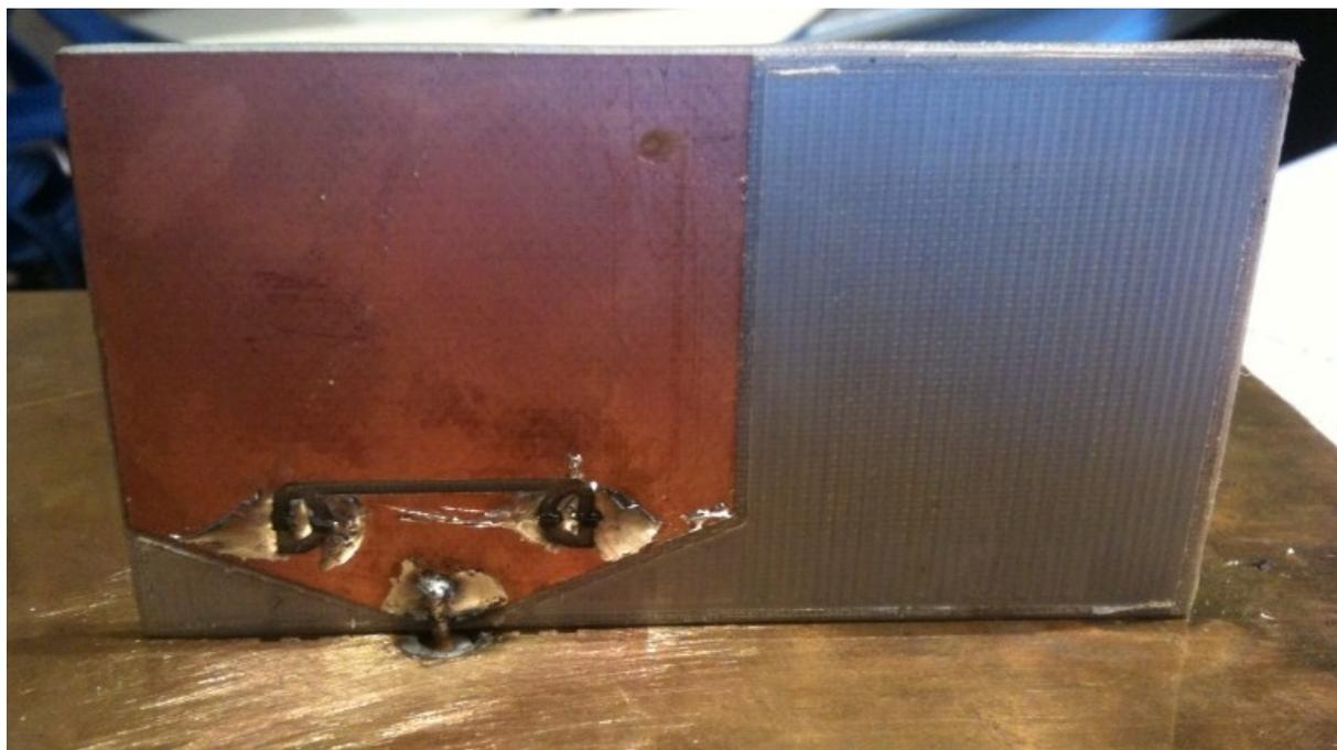
Fig. 4.20 : Photographie de l'antenne réalisée
