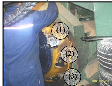
Figure.III.42 : Tête Canter avec ses différents rayons : 1, 2 et 3
