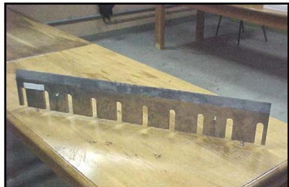
Figure.III.36 : Couteau de dérouleuse 'Sem-automation S500'
