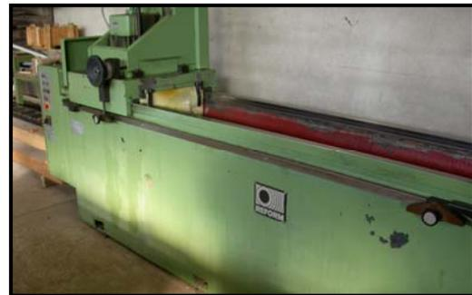
Figure.III.48 : Affûteuse industrielle utilisée
