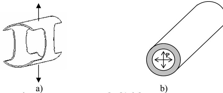
Figure IV. 8. a) traction en sens transversal – b) éclatement
