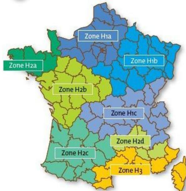
Figure 11 Zone géographique définissant les consommations énergétique maximales pour atteindre le Label BBC Effinergie
