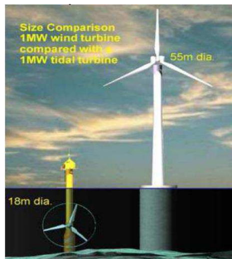
Figure 1: Comparaison d'une turbine hydrolienne à une turbine éolienne pour une puissance de 1 MW tirée de [11]
