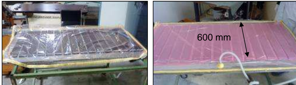
Figure 7: Réalisation des préformes
