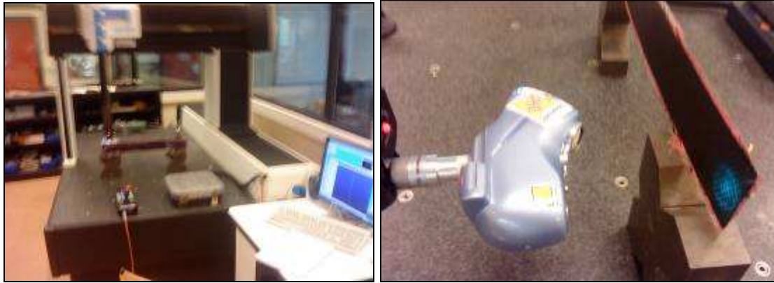
Figure 24: Machine de mesure tridimensionnelle - Capteur scanner KREON
