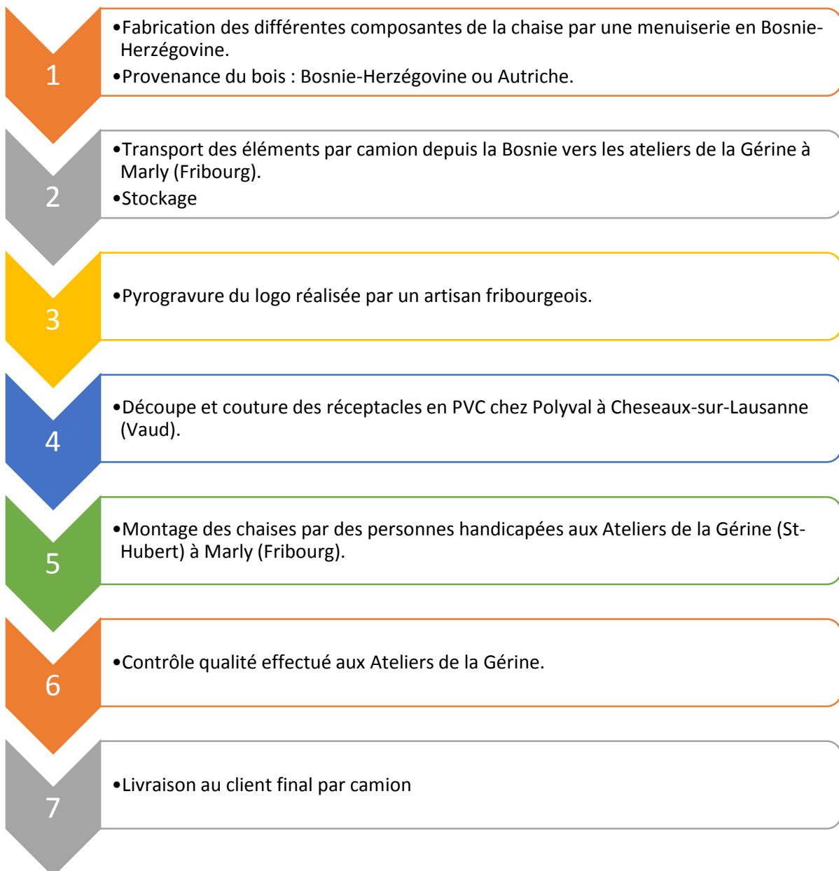
Figure 1 : Représentation du processus de fabrication d'une chaise
