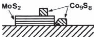
Figure 8 : Modèle d'énergie de contact proposé par Delmon [19]
